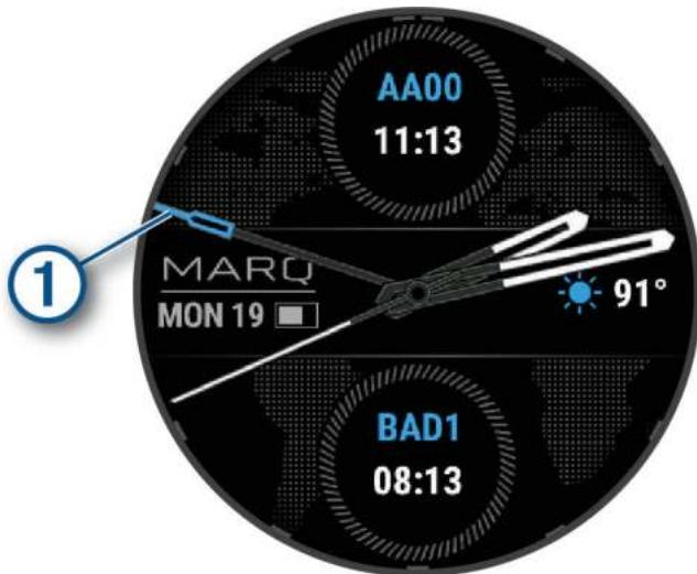
**1** Стрелка всемирного координированного времени (UTC). Отображается при выборе циферблата на 24 деления.
